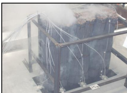
試験開始: 15分目 煙の発生がピークとなる
