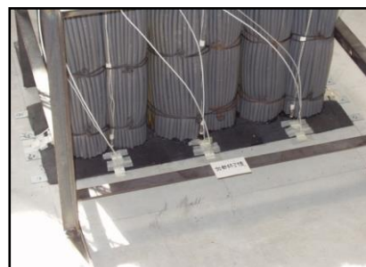
試験開始: 30分目 煙が遮断される
